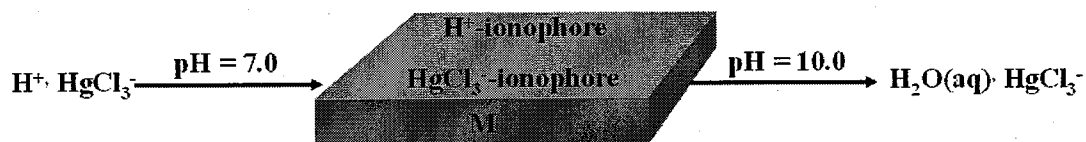
图 4-9 电极再生的工作原理示意图.
