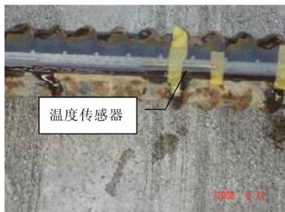
图 2-5 光纤布拉格光栅温度传感器
