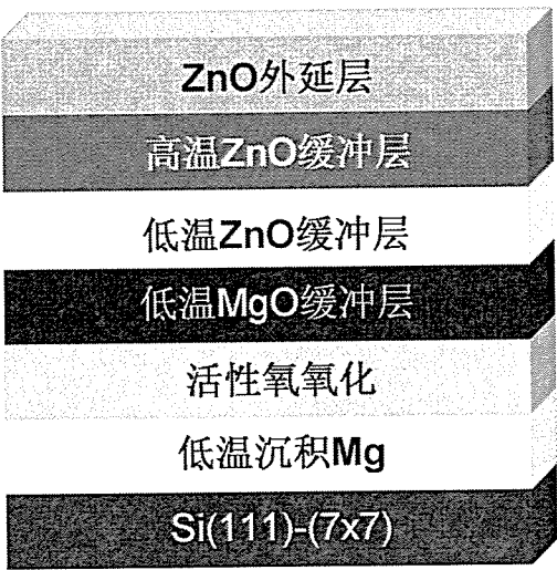
图 3.3 低温界面控制三步法+ZnO 双温缓冲层法制备 ZnO 薄膜生长工艺
