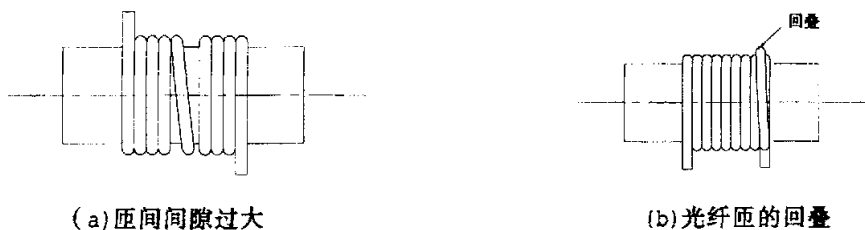
图 1.3 间隙过大和回叠现象
