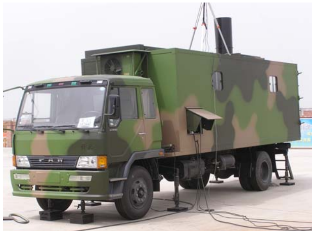
图 4.1 车载式 RML 激光雷达系统的外观图
