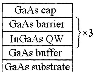
图 3.5 InGaAs/GaAs 多量子阱的结构
