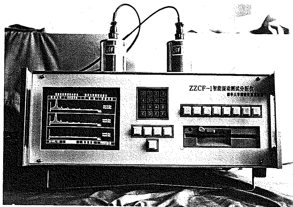
附录图1 基于PC的个人仪器和低频振动传感器（显示振动频谱）
