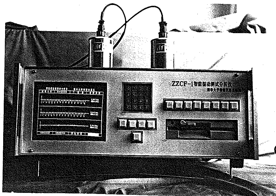
附录图2 基于PC的个人仪器和低频振动传感器（显示振动波形）
