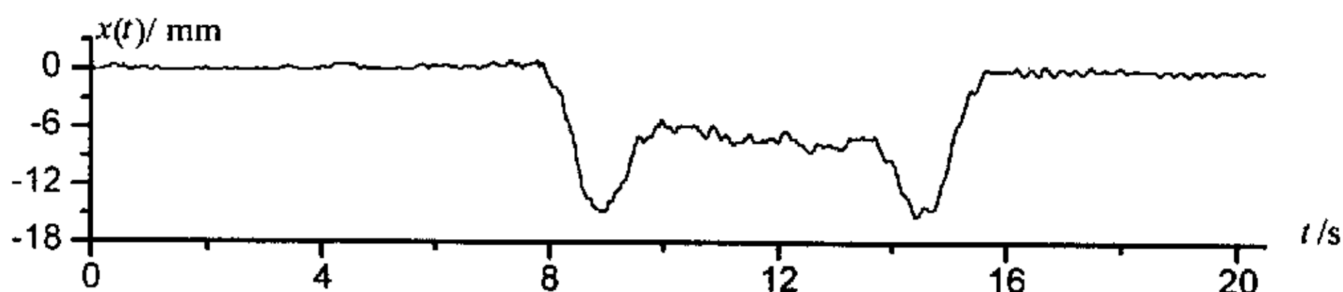
图 6-19 摄像法测试石滩 64m 简支梁动挠度
