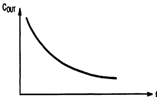
图 3.5 C_{out} 随频率变化图
