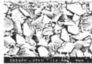
图 4.11 在具有 500nm 厚的 ZnO 覆盖层的蓝宝石衬底上直接生长 GaN 后的表面形貌
