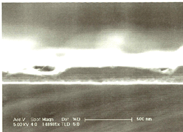
图 4.5 厚度为 400nm 的 N-GST 样品在 170 退火 25min 后的 SEM 结果
