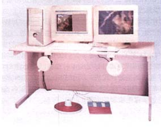
图 1-3 JX4 数字摄影测量工作站外观图
