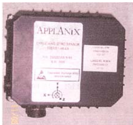
图 2-7 APPLANIX 公司的 IMU 装置
