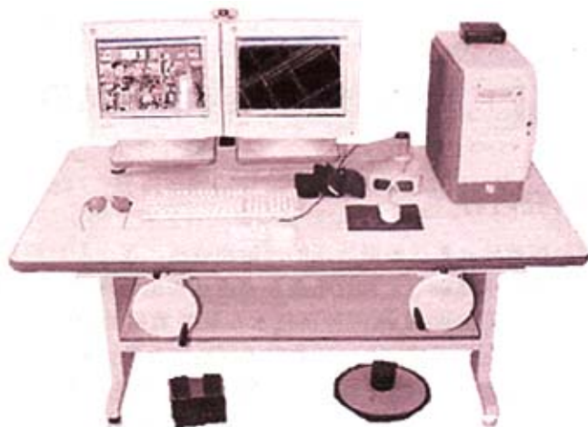
图 1-2 VirtuoZo 数字摄影测量工作站外观图
