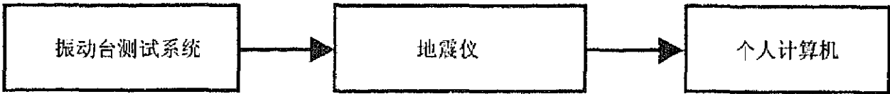
图 1 振动台法地震仪测试设备连接图
