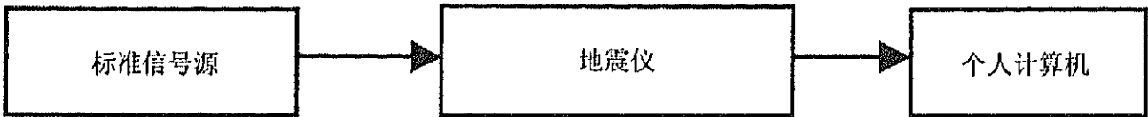
图 4 地震仪测试设备连接图
