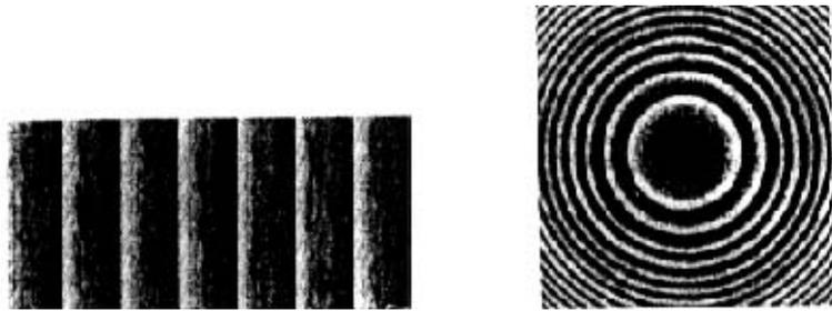
a. 8个灰度级别的闪耀光栅的掩模板 b. 16个灰阶菲涅耳透镜的掩模板
