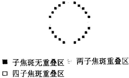
图 4-20 直径  $\phi 570\mu\text{m}$  的近圆形均匀焦斑
