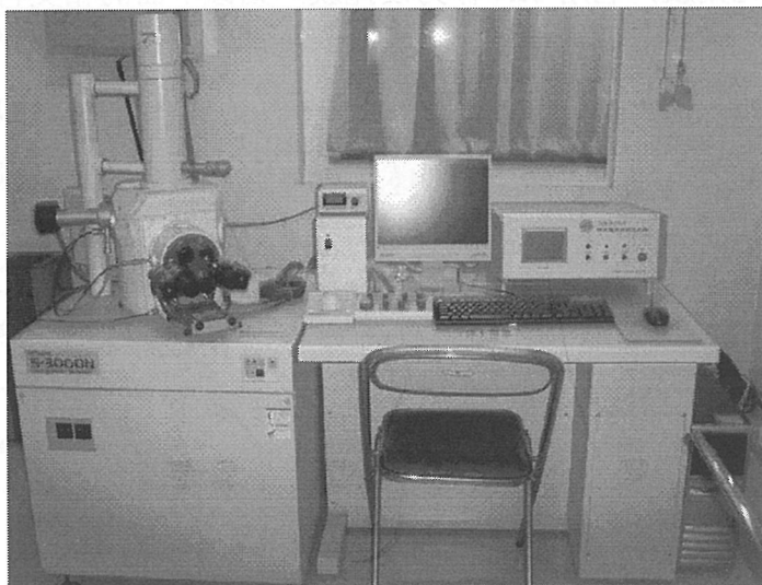
图 3.19 电子束曝光仪器
