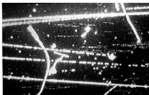
(a) 表面的裂纹 (光学显微镜暗场模式)
