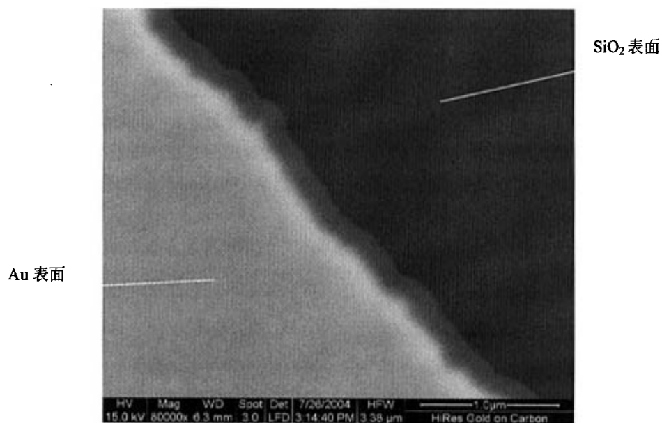
(d) 80 000 倍下在 Au 层表面和 LPCVD SiO 2 表面观察到的、表面质量很好的 SiN 薄膜。
